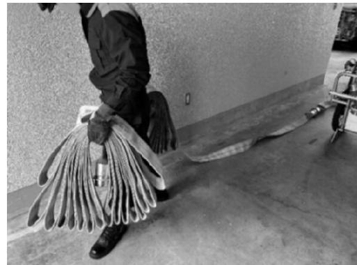
狭隘な路地や建物内、階段などでもそのままホース延長できる
